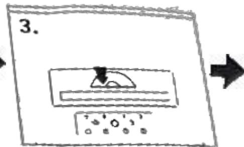
3. Coloque os CDs ou os cartões de crédito na entrada destinada, a máquina irá fragmentar automaticamente.
